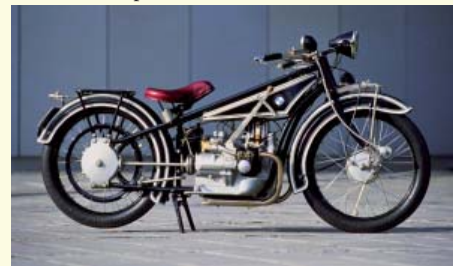
BMW R 32 - transmission par arbre et cardan
