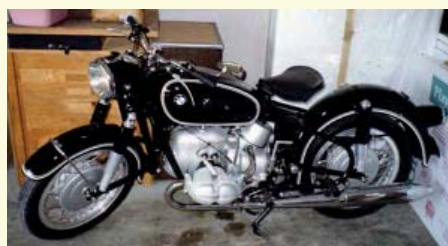
BMW R 69S, construite jusqu'en 1969, la plus puissante des série 2 à fourche Earles
